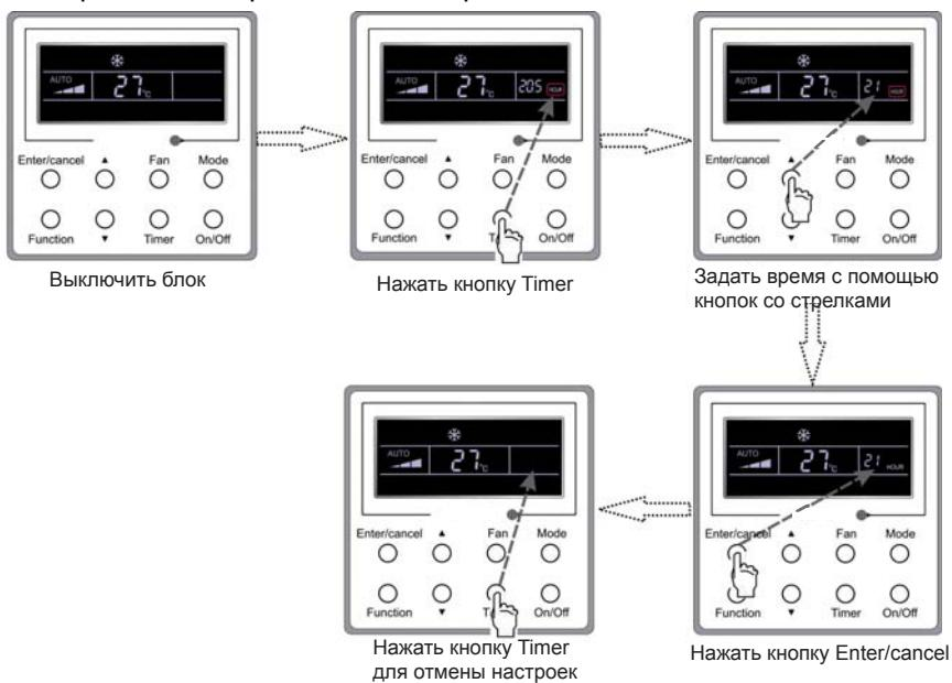
Рис. 8. Последовательность настройки таймера
